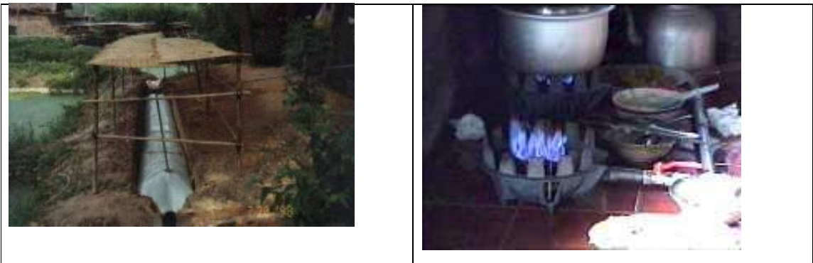
Ảnh 6: Hầm sinh biogas yếm khí đơn giản. Ảnh 7: Sử dụng khí biogas để đun nấu
